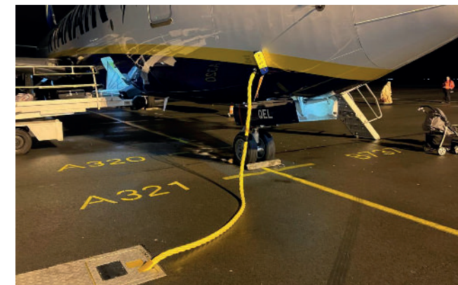
Avion connecté au réseau d'infrastructure 400 HZ Crédits Photos : Aéroport Paris-Beauvais
